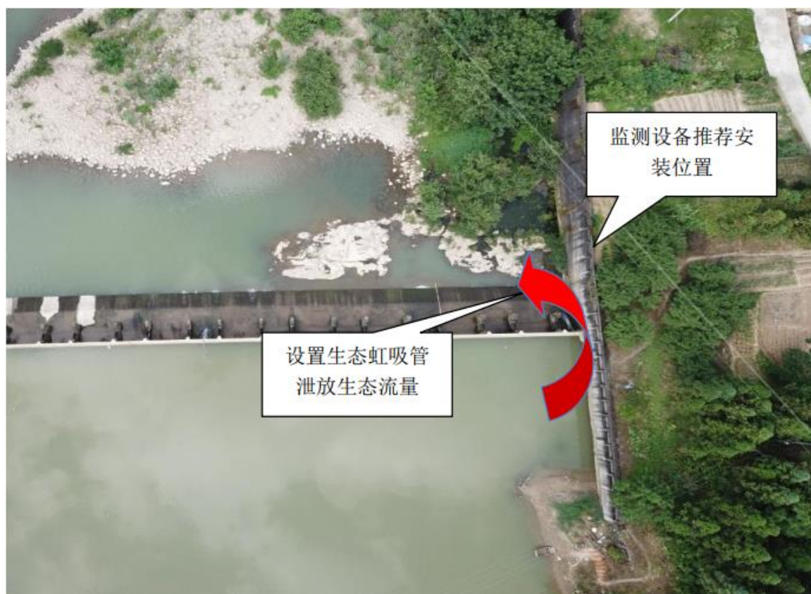
图 5.1-2 深渡水电站监测设备安装位置图
