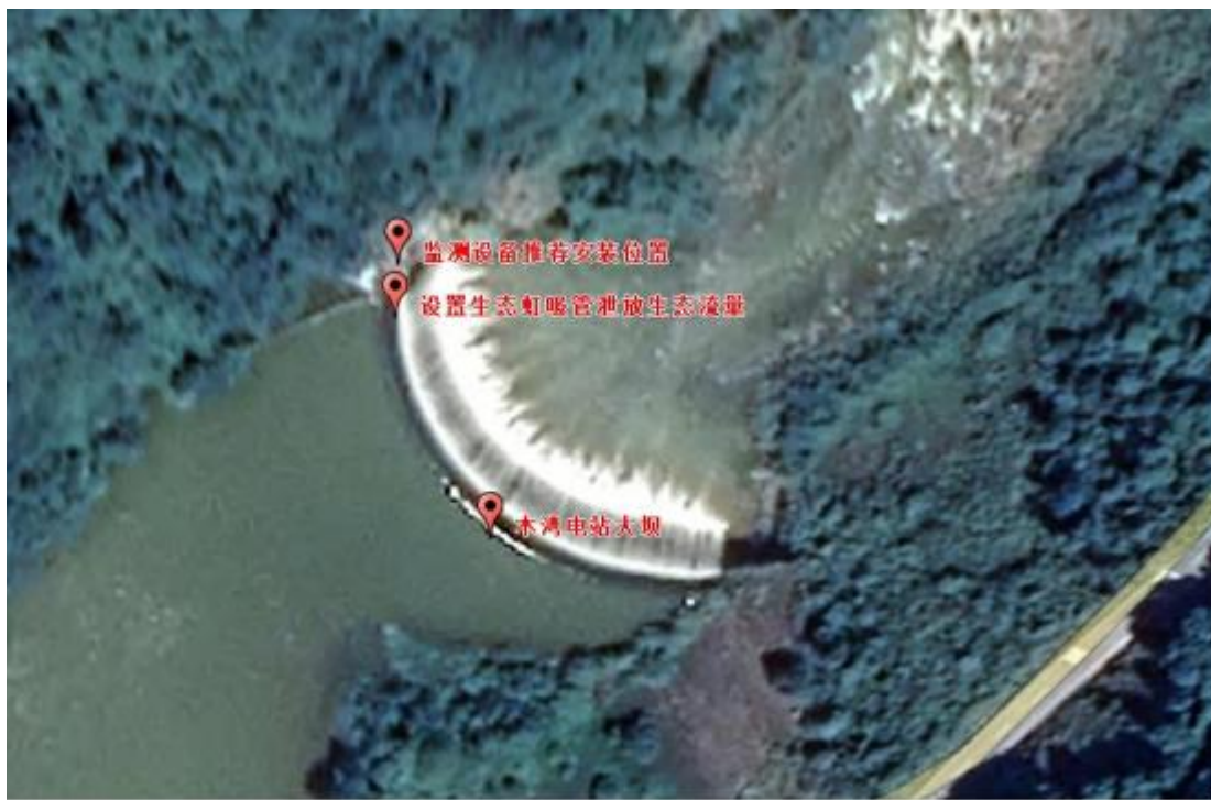
图 5.1-2 木湾水电站监测设备安装位置图
