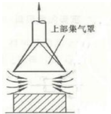
图 7.2-1 顶吸式集气罩设置示意图
