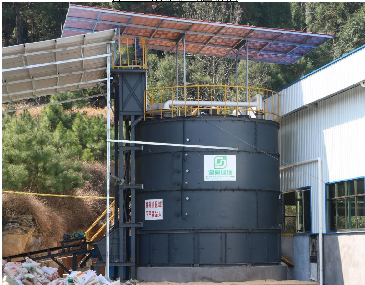
图 3.1-5 有机肥加工装置效果图
